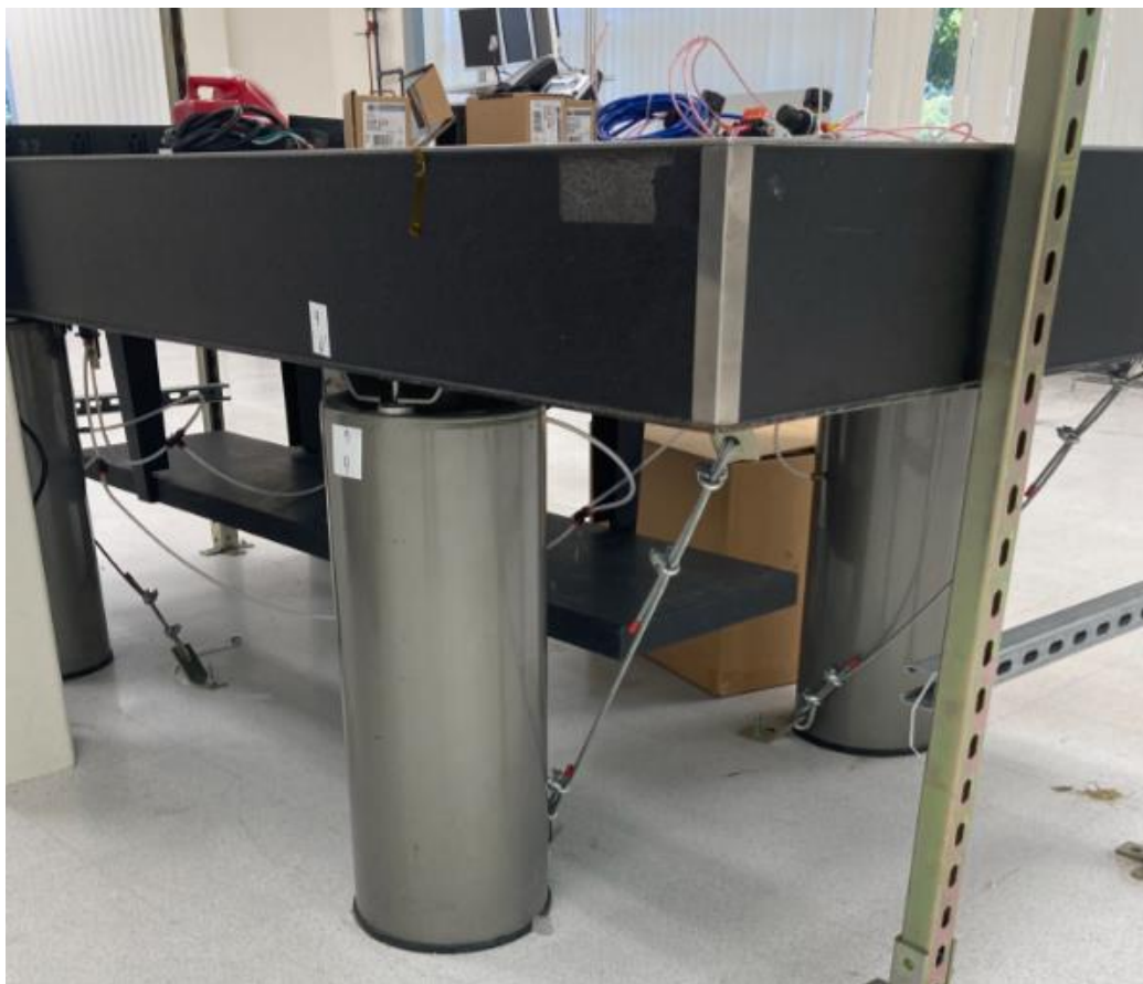
Figura2: Isoladores de vibração pneumático e o tampo da mesa
